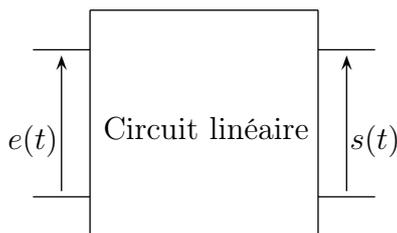
Si le circuit est linéaire, alors le lien entre  $s(t)$  et  $e(t)$  est du type :  $a_m \frac{d^m s}{dt^m} + \dots + a_1 \frac{ds}{dt} + a_0 s = b_n \frac{d^n e}{dt^n} + \dots + b_1 \frac{de}{dt} + b_0 e$ . Pour des raisons de causalité,  $m \geq n$ . On se place en régime sinusoïdale forcé et on utilisera la notation complexe :  $s(t) = S_m \cos(\omega t + \varphi) \rightarrow \underline{s}(t) = \underline{S}_m e^{j\omega t} = S_m e^{j(\omega t + \varphi)}$ .
